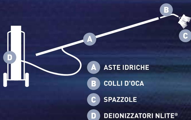
nLite® è un sistema modulare. I singoli componenti possono essere selezionati a seconda della necessità e si adattano perfettamente l'uno con l'altro.
